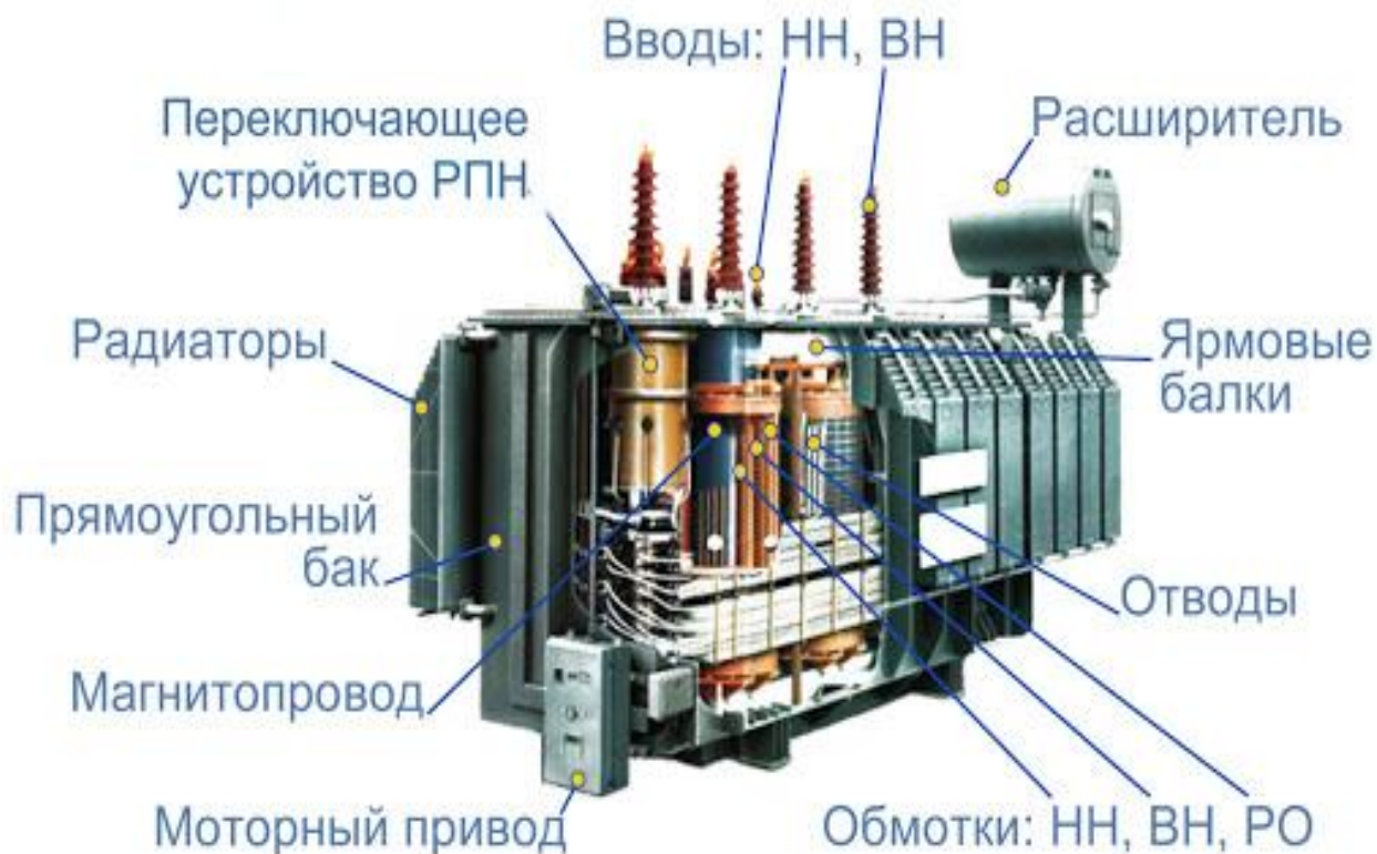
Рисунок 1.2 – Конструкция силового трансформатора
